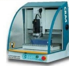
Par enlèvement de matière par fraiseuse avec le Charlyrobot.
