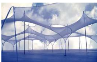
Frei OTTO , Etude exploratoire sur la forme, avec membranes textiles et filets, années 1960-70, Allemagne.
