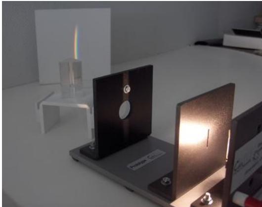
Avec un prisme, un seul spectre lumineux est obtenu, décalé par rapport à la source de lumière
