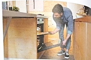
Figura 1 Spazio d'uso insufficiente davanti al forno.
