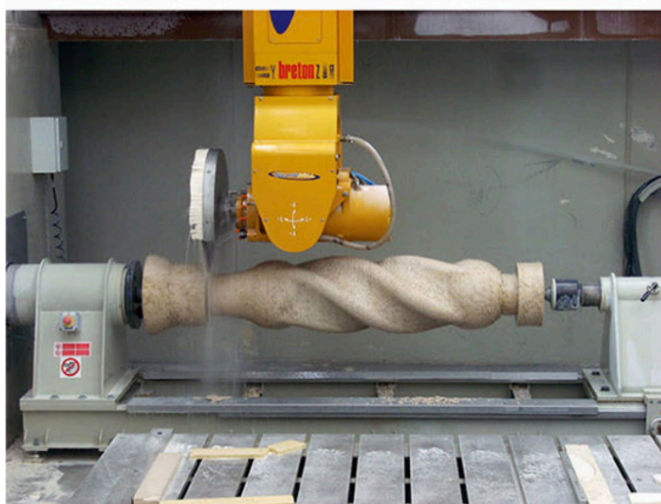
10 Tornio a controllo numerico al lavoro.
