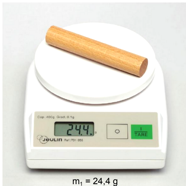
Fig. 1 Pesée du cylindre en bois
