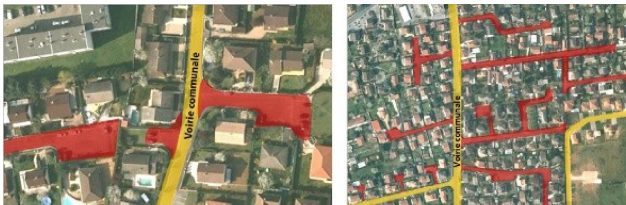
Schémas 2 et 3. Voiries de lotissement en « raquette » et en « arêtes de poisson » à Meyzieu (Rhône).
