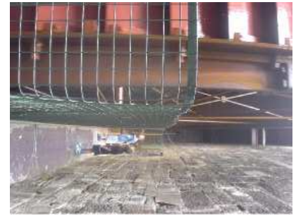
FIGURE 8.4. Une roue à aubes de 60 kW.
