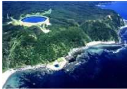
FIGURE 26.11. Centrale de pompage d'Okinawa, dont le réservoir aval est l'océan. Quantité d'énergie stockée : 0,2 GWh. Photo gracieusement fournie par J-Power. www.ieahydro.org .
