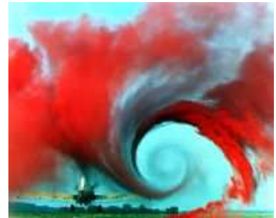
FIGURE C.4. Les flux d'air dans le sillage d'un avion. Photo du Langley Research Center de la NASA.
