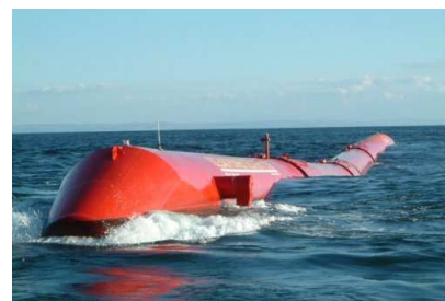
FIGURE 12.1. Un collecteur d'énergie de houle Pelamis est un serpent de mer constitué de quatre sections. Son nez fait face à la houle qui arrive. Les vagues de houle font ployer le serpent, et des générateurs hydrauliques résistent à ces mouvements. La puissance en crête d'un serpent est de 750 kW ; dans le site le plus favorable de l'Atlantique, un serpent fournirait en moyenne 300 kW. La photo est de Pelamis wave power . www.pelamiswave.com .
