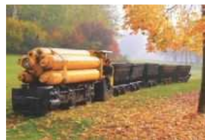
FIGURE 20.24. En haut : un tramway à air comprimé embarquant de l'air et de la vapeur à Nantes. Alimenter les tramways de Nantes consommait 4,4 kg de charbon (36 kWh) par véhicule-km, soit 115 kWh pour 100 p-km si les tramways étaient complets. [5qhvcb] En bas : Une locomotive à air comprimé; poids : 9,2 tonnes; pression : 175 bars; puissance : 26 kW. Photo gracieusement fournie par Rüdiger Fach, Rolf-Dieter Reichert, et le Frankfurter Feldbahnmuseum.
