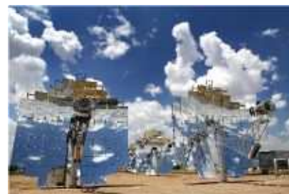
FIGURE 25.3. Moteurs Stirling à parabole. Ces magnifiques concentrateurs fournissent une puissance par unité de surface de 14 \text{ W/m}^2 . Photo gracieusement fournie par Stirling Energy Systems. www.stirlingenergy.com
