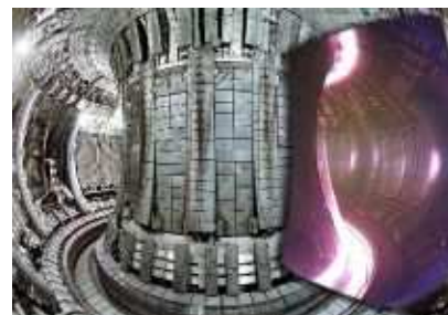
FIGURE 24.15. L'intérieur d'un réacteur à fusion expérimental. L'image partagée montre le réservoir de vide du JET (Joint European Torus) avec, en surimpression, une image d'un plasma dans le JET, prise avec une caméra de télévision classique. Photo : EFDA-JET.
