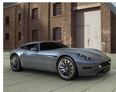
FIGURE 20.39. Lightning : 11 kWh pour 100 km . Photo de www.lightningcarcompany.co.uk .
