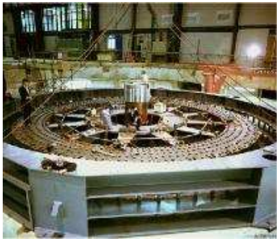
FIGURE 26.15. Un des deux volants d'inertie au centre de recherche sur la fusion de Culham, en construction. Photo : EFDA-JET. www.jet.efda.org .
