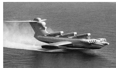
FIGURE C.16. Le Lun, un ékranoplane — un peu plus long et lourd qu'un Boeing 747. Photographies : A. Belyaev.
