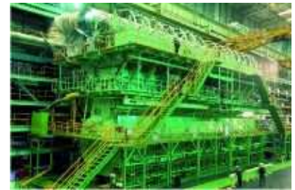
FIGURE A.15. Le moteur Diesel 2-temps Wartsila-Sulzer RTA96-C et ses 14 cylindres. Il fait 27 mètres de long et 13,5 mètres de haut. www.wartsila.com
