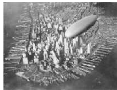
FIGURE C.14. L'USS Akron (ZRS-4), long de 239 mètres, au-dessus de Manhattan. Il pesait 100 tonnes et pouvait transporter 83 tonnes. La puissance totale de ses moteurs était de 3,4 MW, et il pouvait transporter un équipage de 89 personnes et un chargement d'armes à 93 km/h. Il servait aussi à transporter des avions.
