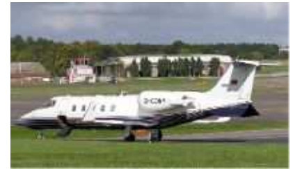
FIGURE C.10. « Attachez vos ceintures. » Un Bombardier Learjet 60XR, qui transporte 8 passagers à 780 km/h, a un coût de transport de 150 kWh pour 100 passagers-km. Photographie par Adrian Pingstone.
