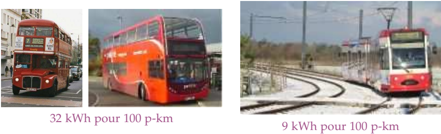
FIGURE 20.7. Quelques transports publics, et leur consommation moyenne d'énergie. A gauche : Quelques célèbres bus rouges britanniques. A droite : Le tramway de Croydon. Photos de Stephen Parascandolo.
