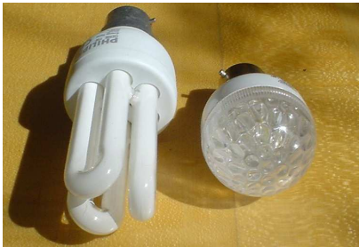
FIGURE 9.4. Ampoule Philips de 11 W à côté d’une ampoule à LED de 1,3 W.
