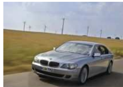
FIGURE 20.26. BMW Hydrogen 7. Consommation d'énergie : 254 kWh pour 100 km . Photo de BMW.
