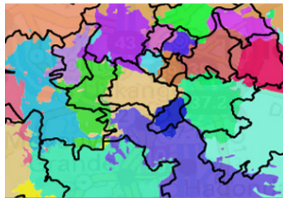
Illustration 20 – Découpage de la région Grand Est par des zones de détection de la téléphonie mobile. Les limites théoriques, basées sur un découpage communal, sont représentées en noir. Le zonage de couverture des télécommunications de l'opérateur est représenté sous la forme d'une palette de couleur (Source : Opérateur)
