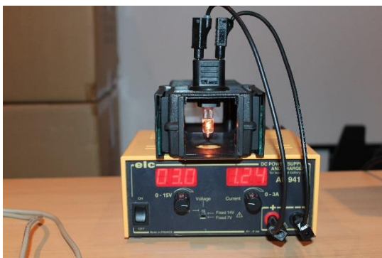
Figure 19 : variation de la couleur de la lumière émise suivant la tension d'alimentation (3 V puis 12,2 V) et donc de la température.
