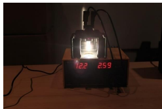
Figure 19 : variation de la couleur de la lumière émise suivant la tension d'alimentation (3 V puis 12,2 V) et donc de la température.
