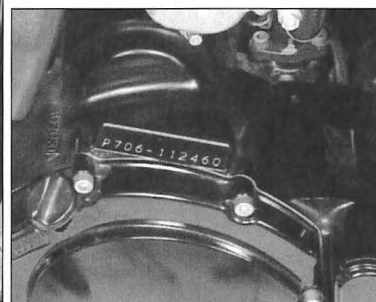
Emplacement du numéro de série du moteur au dessus du couvercle d'embrayage.
