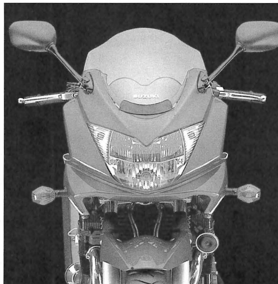
Le carénage de tête de fourche de la version « S » est plus anguleux que celui installé sur le modèle 600 cm 3 .
