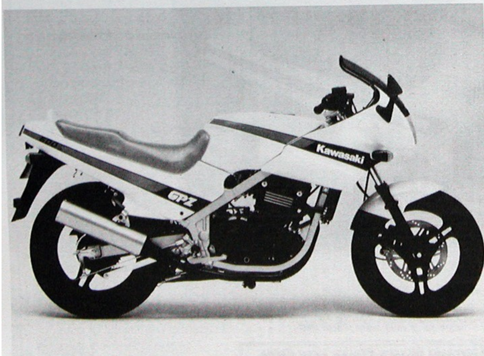
Dans sa première version, la GPZ 500 S ne reçoit pas de sabot de carénage. De plus la roue avant n'est équipée que d'un seul disque.
