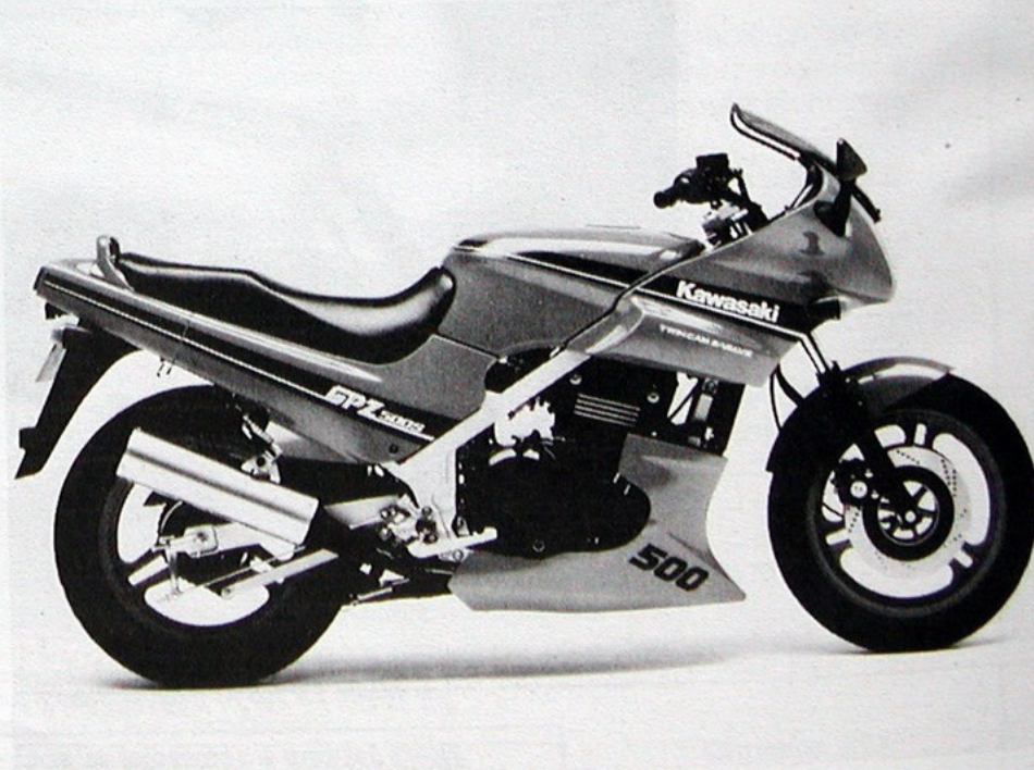
La version 1988, celle qui reçoit le plus de modifications : Double disque avant, sabot de carénage de série, nouveau coloris et nouveaux sigles.
