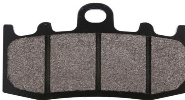
Plaquette en métal fritté avec quatre éléments de friction séparés
