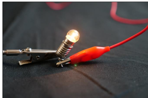
Une seule lampe 3,5V dans le circuit ne permet pas d'observer le filament.
