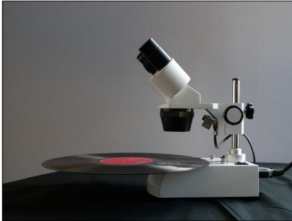
Observation à la loupe binoculaire d'un disque vinyle. Grossissement x40.
