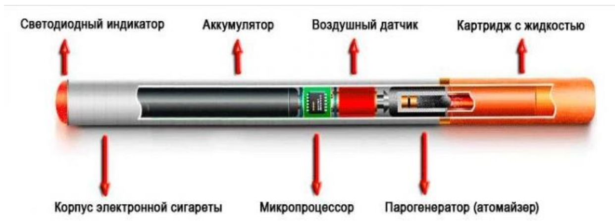
Рисунок 1 - Строение электронной сигареты
