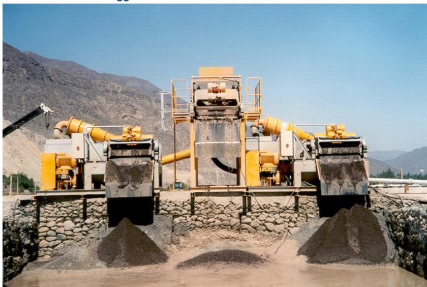
Fig 1 Bauer dissabbiatore BE 500
