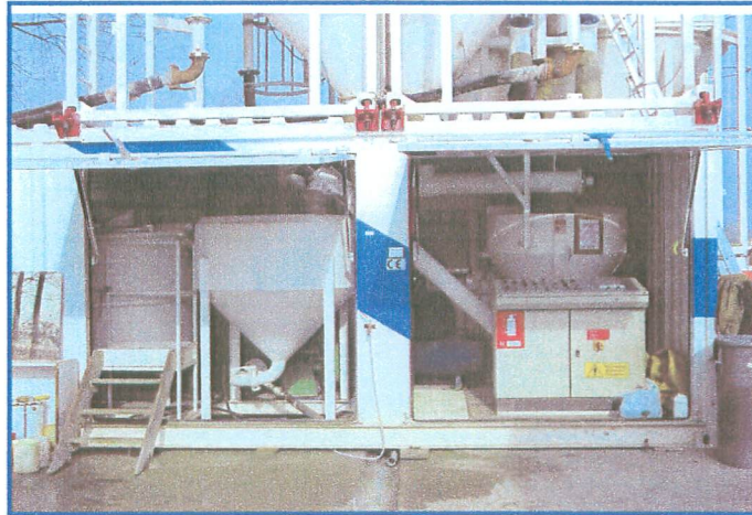
Figura 10: impianto di confezionamento miscela cementizia
