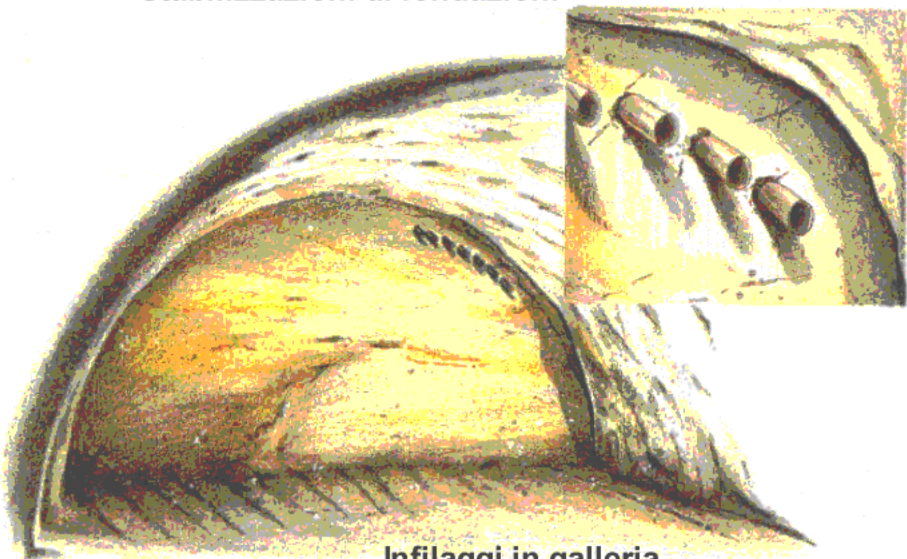
Infilaggi in galleria
