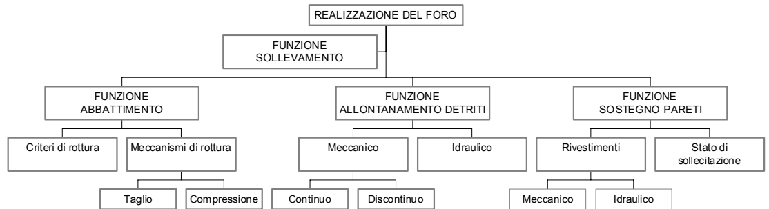
Figura 31 – Le diverse funzioni e rispettive metodologie che sottendono all'esecuzione di un pozzo
