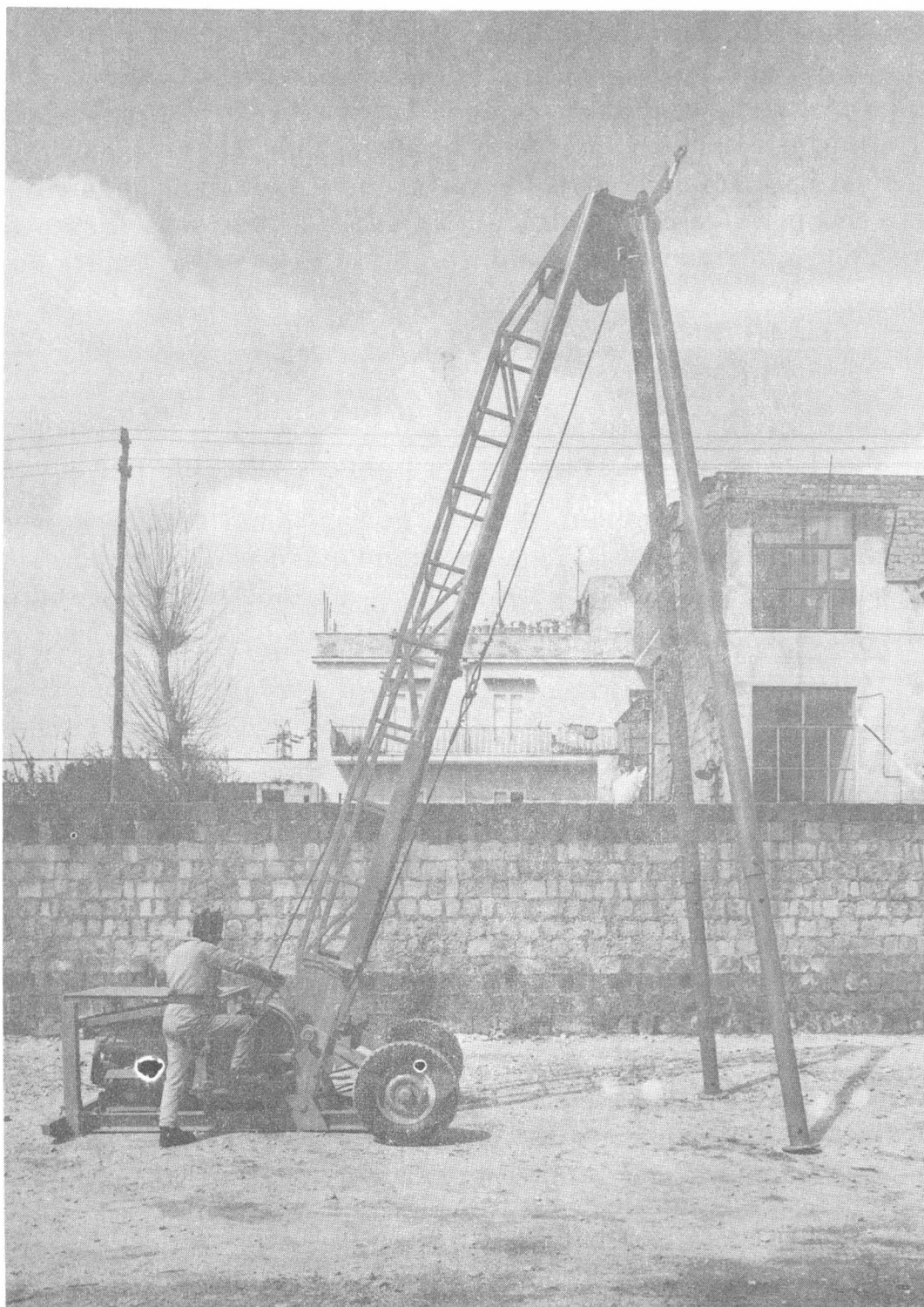
Fig. 2-1 - Attrezzatura trainabile per sondaggi a percussione.
