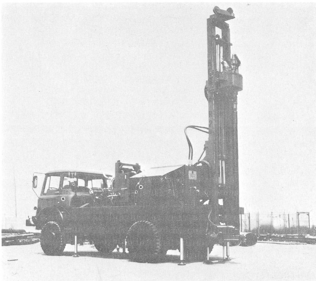
Fig. 2-2 - Sonda a rotazione Reska R2.
