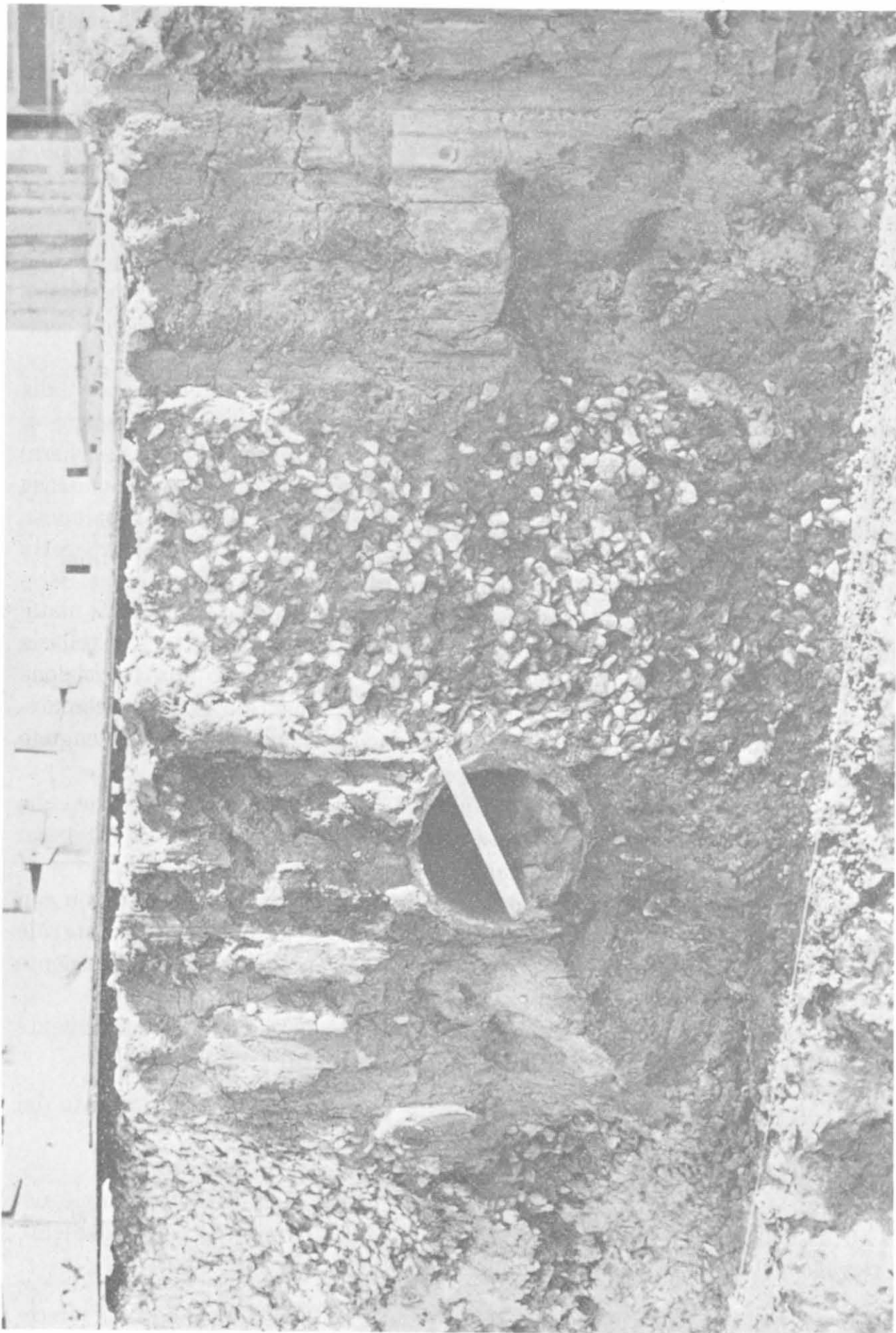
Fig. 7-25 - Vibroflottazione: colonna granulare in terreni argillosi (Cementation).
