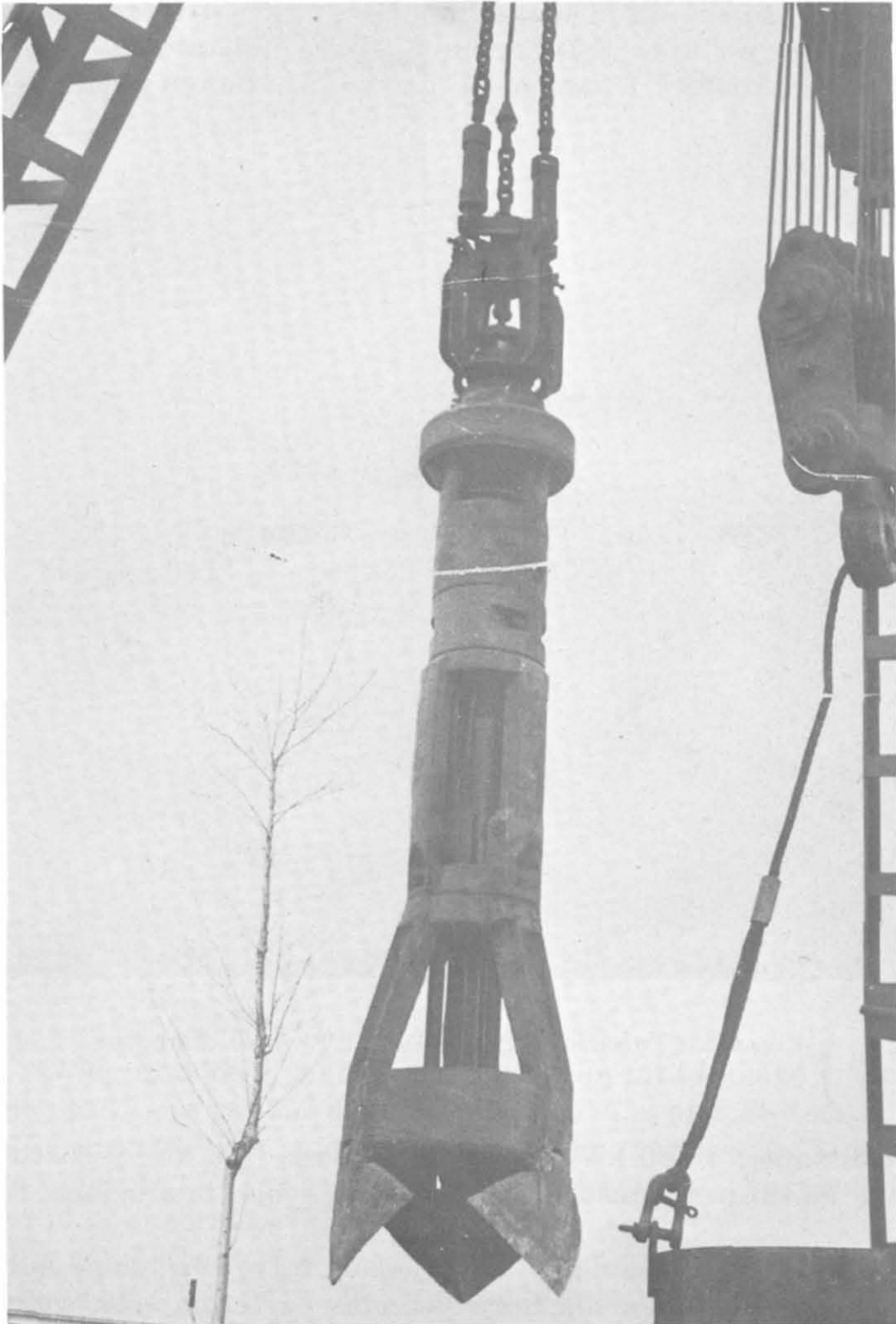
Fig. 6-4 - Particolare di una benna aperta con le ganasce bloccate.
