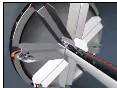
Raccolta dei detriti nel tubo centrale
